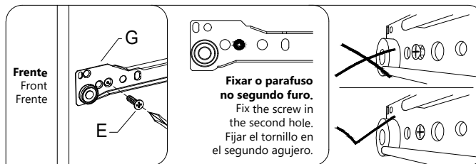
Detalhe D Detail D / Detalle D
